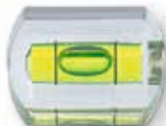
Vial 34 x 22 x 14 mm R 180 mm \pm 38 min. Article N°. 680 034
